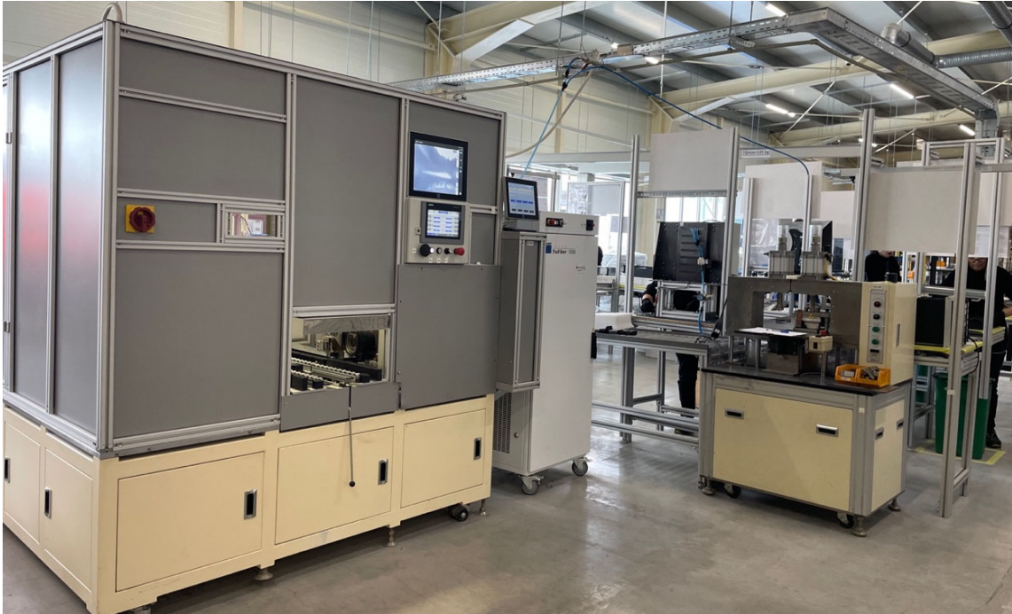
Celula pilot de procesare laser a tab-urilor din componența bateriilor electrice reîncărcabile amplasată pe linia de asamblare de la operatorul comercial
