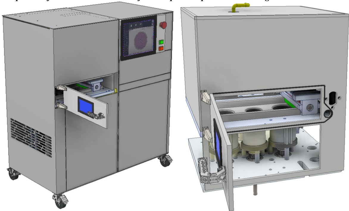
Sistemul integrat de procesare laser a materialelor metalice sub formă de pulbere în vederea obținerii de componente cu aplicabilitate în domeniul medical
