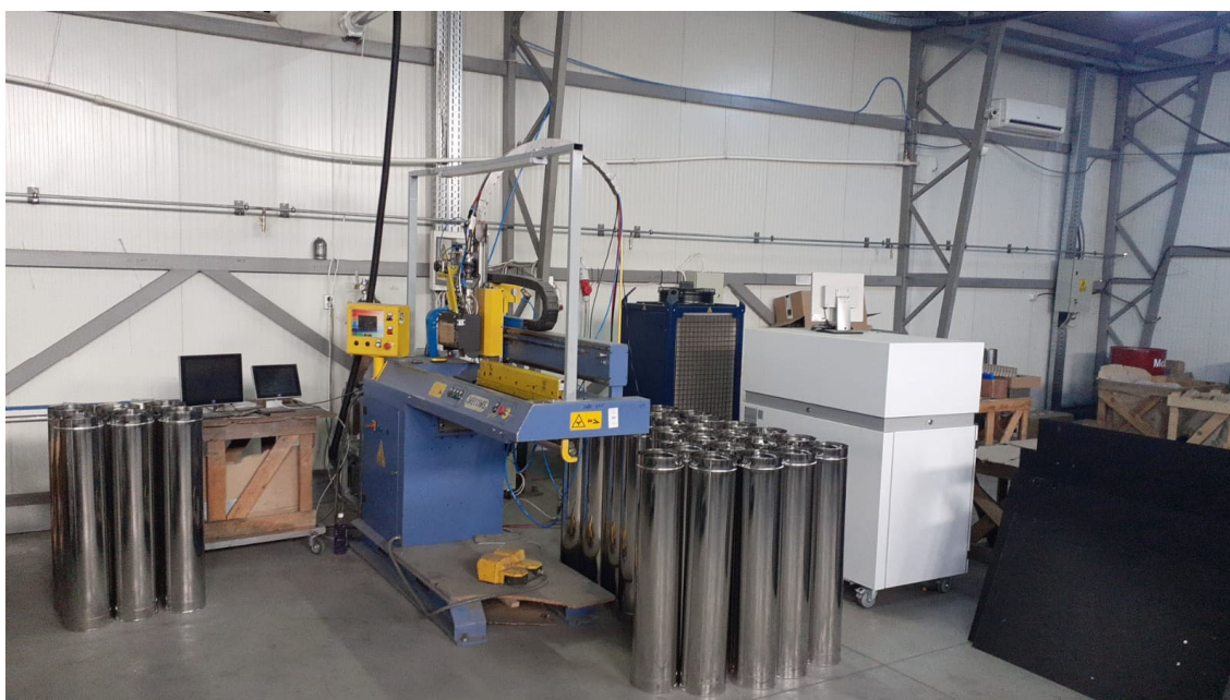
Procesarea laser în condiții reale de funcționare a elementelor metalice ce alcătuiesc coșurile de fum
