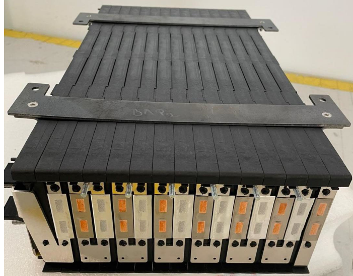
Sistem de stocare a energiei electrice in baterii litiu-ion cu contacte imbinare prin sudare laser
